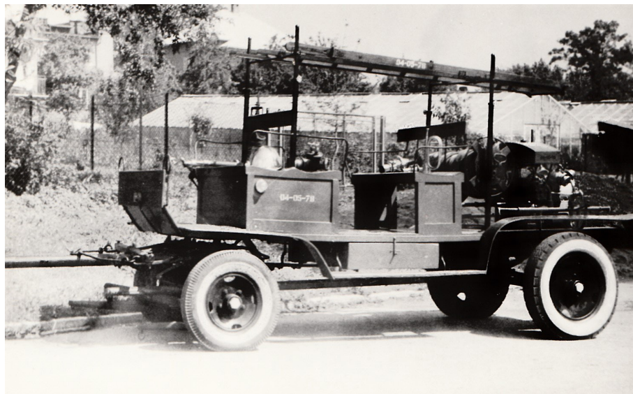
OSP Inwałd, fot. 9 Wóz strażacki przystosowany do zaprzęgu ciągnikowego i konnego, 1964 r.
